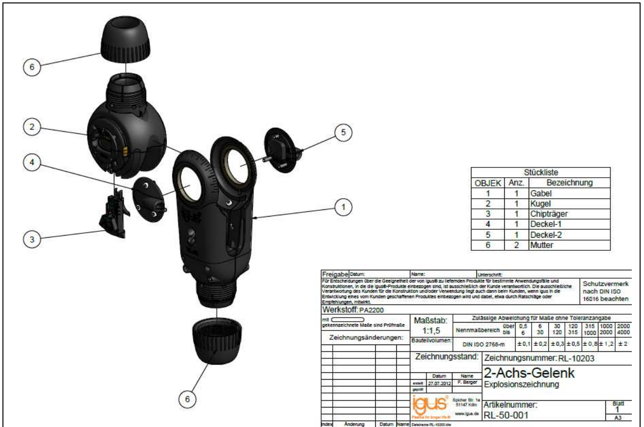
Abb. 55: Explosionszeichnung / Stückliste 2-Achs-Gelenk RL-50-001 (-002)
