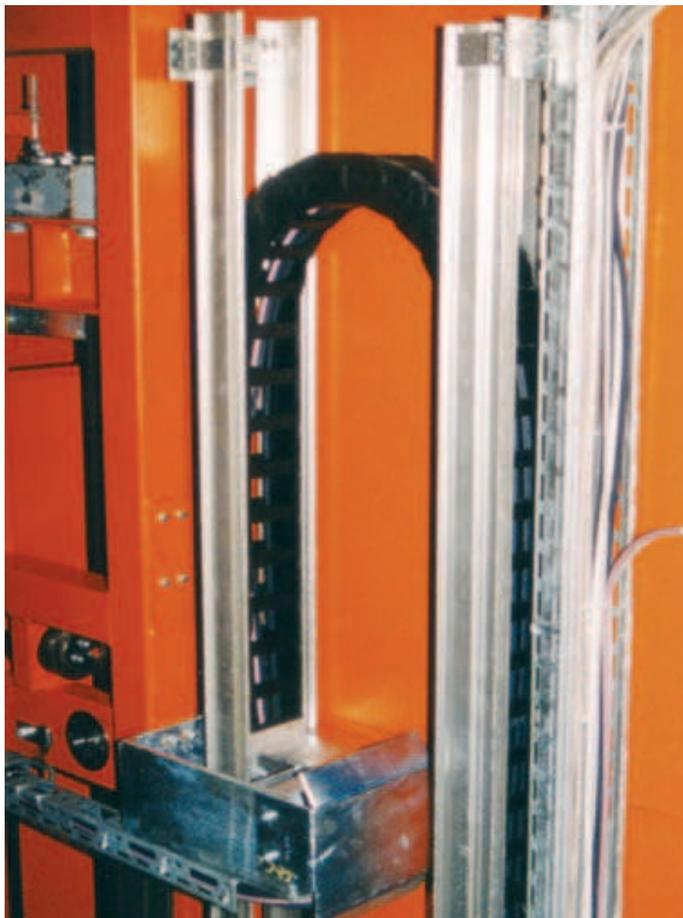
e-kette® am Mast von Regalbediengerät rollt sich von der einen in die gegenüberliegende Aluminium-Führungsrinne ab
