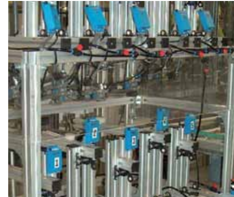
Schwenkverschleiß-Prüfstand zur Prüfung der Verschleißrate schwenkend, für mittlere Belastungen Oscillating wear test rig for testing the wear in oscillating movements at medium loads
