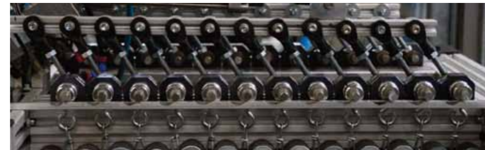
Schwenkverschleiß-Prüfstand zur Prüfung der Verschleißrate schwenkend, für mittlere Belastungen Oscillating wear test rig for testing the wear in oscillating movements at medium loads
