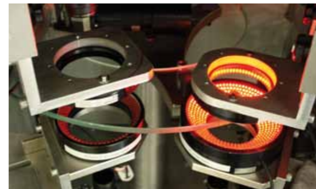
Optische Sortieranlage - 100% Kontrolle mit bis zu 10 Teilen/s Optical tests on automatic systems - 100% control, up to 10 pieces per second
