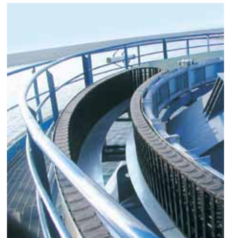
RBR-Ketten RBR chains: S-förmig für Kreisbewegungen S-shaped for circular motions
