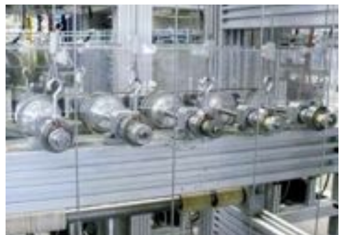
Prüfstand für xiros®-Polymerkugellager im igus®-Labor
