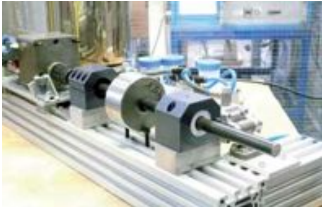
Prüfstand für xiros®-Polymerkugellager im igus®-Labor
