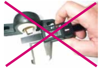
Falsches Prüfmittel; Mess-Schieber
