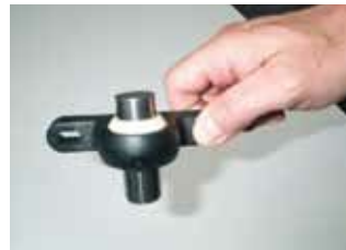
Toleranzprüfung mit Lehrdorn
