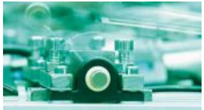
Ermittlung der maximalen Gleitgeschwindigkeit eines igugal®-Stehlagers
